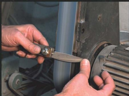
Molatura della lama | *Grinding of the blade*
