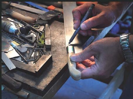
Foratura del perno | *Drilling of the pin*
